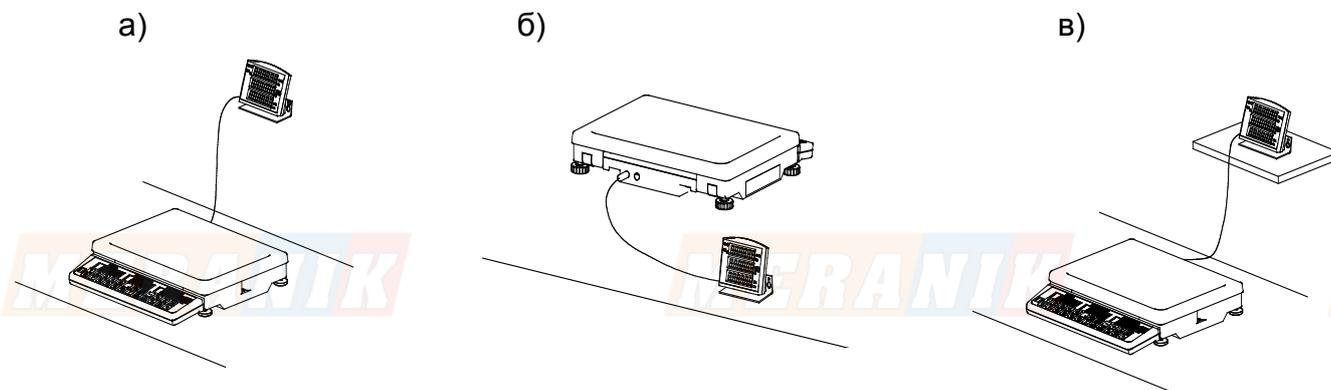
Рис. 7.1 - Варианты установки выносного индикатора ИВ-4Т
